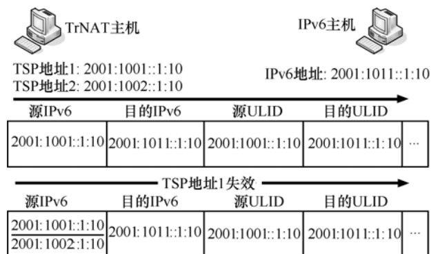
图 5 NAT 主机使用 Shim6 协议通信过程
